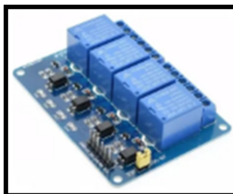
Figura 07- Módulos Relé de 4 canais Fonte: [13]
